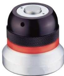
上記写真のような機器をテーブル上に搭載し、工具を手動で少しずつ下げ、LED 等のランプが点灯したポジションを工具長とします。安価で 8,000 円ぐらいから、精度の高いものは 80,000 円程度で販売されております。
