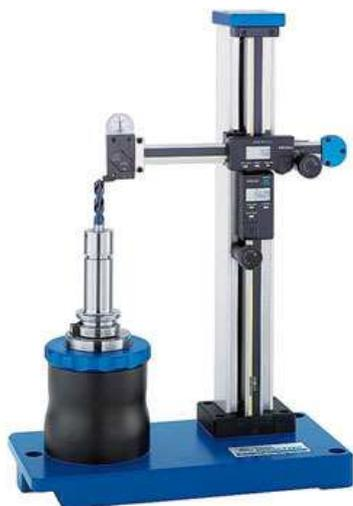
一般的なメカニカルツールプリセッター 接触子を手動で当てながら測定を行います。
