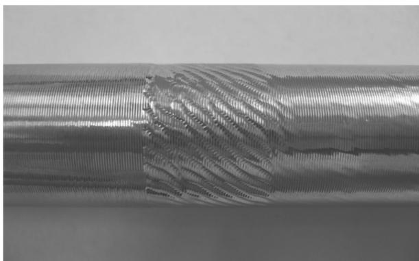
図1 旋削加工で発生したびびり振動の典型例
