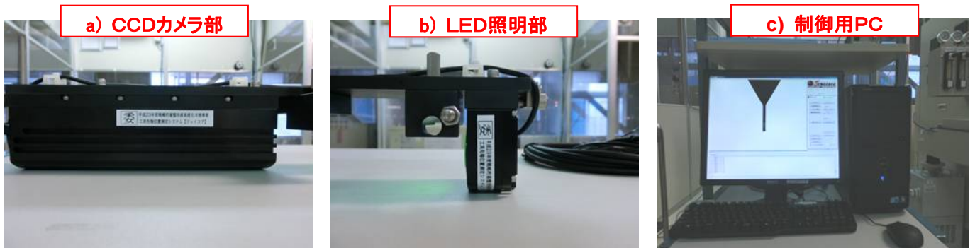
図-1 工具先端位置測定システム【ジェイコア】外観
